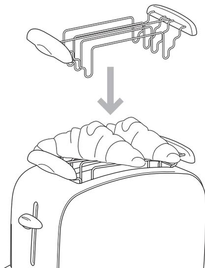
付属のパン温め器を入れ口に取り付けます。入れ口のフタが開いたままになり、熱が温め器まで届くようになります。クロワッサンやバターロールなど丸型のパンを温め器の上に載せ、レバーを押し下げます。焦がさずに温める場合はREHEATボタンを押します。約30秒でスイッチが切れ、レバーが上がります。よく焼く場合は、REHEATボタンを押さずに焼き加減を見てCANCELボタンを押してスイッチをオフにしてください。冷凍パンやパン以外のは使用しないでください。また、アルミホイルを使用しますと熱が伝導してハンドル部分のプラスチックが溶解するので、パンをそのまま載せてください。
