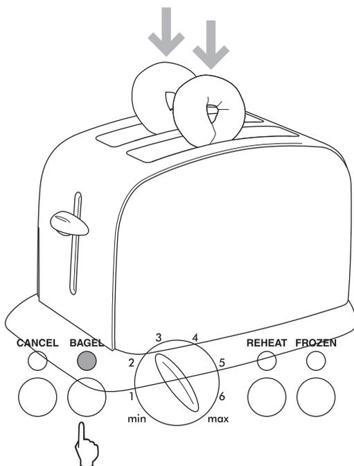
このトースターにはベーグル専用の調節機能が付いています。ベーグルを二つに輪切りにして、それぞれ入れ口に入れ、濃淡調節ツマミをお好みの位置にセットします。ポップアップレバーを押し下げてBAGELボタンを押します。ベーグル表示灯が点灯し、焼き時間を自動的に調節します。ベーグルは片面焼きと両面焼きがありますが、このトースターは両面焼きタイプです。片面焼きにしたい場合はパン温め器を使ってください。
