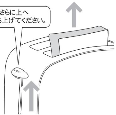
パンが焼き上がるとポップアップします。ポップアップしたらレバーをさらに手で持ち上げてパンを取り出します。
