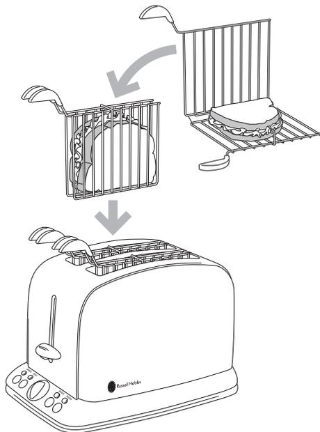
付属のサンドイッチラックは、ホットサンドを作る時や小さなパンを焼く時に使います。最大3cmの厚さまで使用できますが、サンドイッチの場合は1枚のパンの厚さが約1.3cm(10枚切り)以下のパンを使用してください。また、間に挟む具が、パンからはみ出さないようにしてください。特にベーコンなどの脂分の多いもの、チーズなどは溶け出して下に垂れてしまうようなものはご注意ください。中の具が重いと、ポップアップされない場合がありますが、設定時間になりますと自動的にスイッチが切れます。CANCEL灯が消えたら、サンドイッチラックのハンドルを持ち上げて取り出してください。
