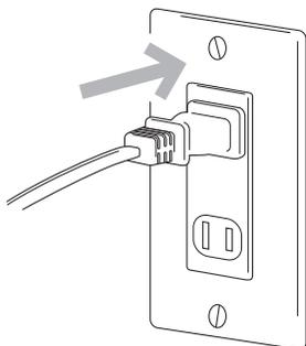
カーテンなどの可燃物から十分に離し、堅く、平らな、耐熱性のある台の上に置いてください。少しの熱でも影響を受けるようなものの上には置かないでください。電源プラグをコンセントに差し込んでください。
