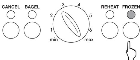
まず、濃淡調節つまみを2以上で、お好みの位置にセットします。解凍時間は自動調節されますので、通常のパンを焼く場合と同じ位置になります。冷凍パンを入れ口に入れ、レバーを押し下げ、FROZENボタンを押します。FROZEN灯が点灯し、解凍、焼き上げを自動的に調節します。
