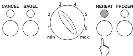
一度焼き上がった後、冷めてしまったトーストを温め直すことができます。冷めたトーストを入れ口に入れ、ポップアップレバーを押し下げ、REHEATボタンを押します。REHEAT灯が点灯し、約30秒間加熱してポップアップします。すっかり冷めてしまったトーストなどでは、適度な温かさになるまで繰り返してください。この時バターが塗られたトーストは入れないようご注意ください。
