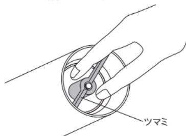
ツマミ部分には、細い矢印と、太い矢印のマークが記されています。ツマミを細い矢印方向に回転すると細挽きに、太い矢印方向に回転すると粗挽きになります。
