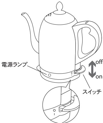
電源プラグをコンセントに差し込み、電源スイッチを押し下げます。湯沸し中には電源ランプが点灯します。湯沸し途中でケトル本体を持ち上げると電源スイッチは自動的にオフになります。
