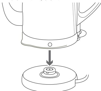
ふたを確実に閉めて、パワーベースにセットします。パワーベースを水平で安定した場所に設置し、本体底のコネクター接続部がしっかりととはまるようにケトルをセットします。
