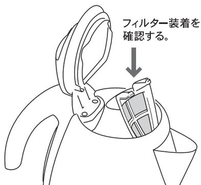
ケトル本体をパワーベースから取り外します。フィルターが正しく装着されていることを確認して、水を入れます。(0.5L～1.7L) 満水目印(MAXマーク)位置以上に水を入れしないでください。
