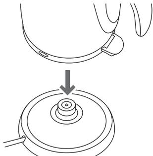
ふたを確実に閉めて、パワーベースにセットします。パワーベースを水平で安定した場所に設置し、本体底のコネクター接続部がしっかりとハマるようにケトルをセットします。
