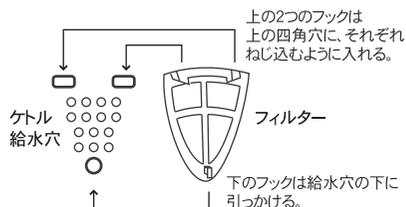
フィルターが正しく装着されていないと、自動電源オフ機能が働きにくくなります。
