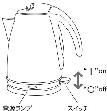
電源プラグをコンセントに差し込み、電源スイッチを押し上げます。湯沸し中には電源ランプが点灯します。湯沸し途中でケトル本体を持ち上げると電源スイッチは自動的にオフになります。
