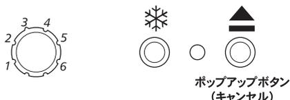
途中で焼くのを中止したい場合は、ポップアップボタンを押します。電熱線のスイッチが切れ、パンがポップアップします。
