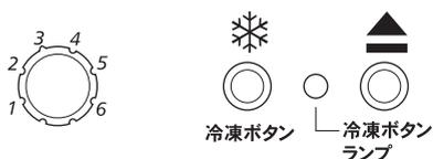
まず、濃淡調節つまみをお好みの位置にセットします。解凍時間は自動調節されますので、通常のパンを焼く場合と同じつまみ位置になります。冷凍パンを入口に入れ、レバーを押し下げ、冷凍ボタンを押します。解凍、焼き上げが自動的に調節されて焼き上がります。
