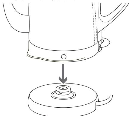
ふたを確実に閉めて、パワーベースにセットします。パワーベースを水平で安定した場所に設置し、本体底のコネクター接続部がしっかりとはまるようにケトルをセットします。
