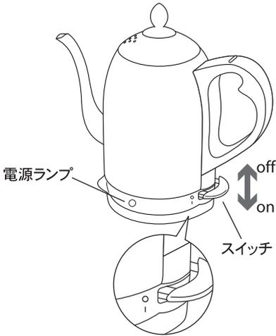
電源プラグをコンセントに差し込み、電源スイッチを押下げます。湯沸し中には電源ランプが点灯します。湯沸し途中でケトル本体を持ち上げると電源スイッチは自動的にオフになります。
