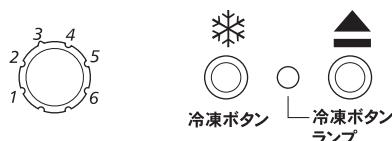
まず、濃淡調節ツマミをお好みの位置にセットします。解凍時間は自動調節されますので、通常のパンを焼く場合と同じツマミ位置になります。冷凍パンを入れ口に入れ、レバーを押し下げ、冷凍ボタンを押します。解凍、焼き上げが自動的に調節されて焼き上がります。
