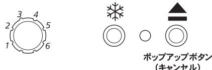
途中で焼くのを中止したい場合は、ポップアップボタンを押します。電熱線のスイッチが切れ、パンがポップアップします。
