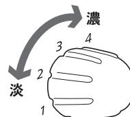
まず濃淡調節ツマミをお好みの位置に合わせてから、トースターのスイッチを入れます。(ポップアップレバーを下げる)トースターのスイッチが入ってから調節ツマミを変えても最初の設定から変更できません。
