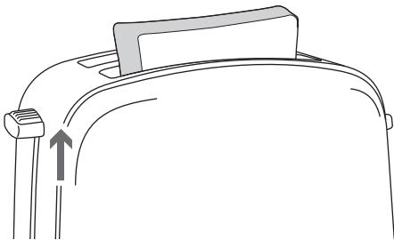
パンが焼き上がるとポップアップします。ポップアップしたらレバーをさらに持ち上げてパンを取り出します。
