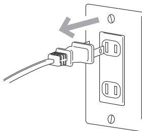
カッターブレードの回転が止まったら電源プラグを抜く。
