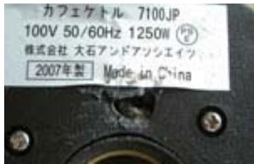
(左記写真) 本体の内部配線が過熱することにより、**本体底面の樹脂パーツの一部が破損する不具合です。**なお、本体内部には過温度上昇防止機能が組み込まれており、本体底面の樹脂パーツは難燃性の素材を使用しておりますので、**延焼する心配はございません。**
