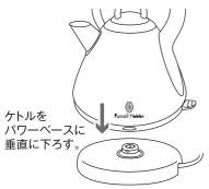
ふたを確実に閉めます。パワーベースを 水平で安定した場所に設置し、ケトルをパ ワーベースに垂直に下ろしてセットします。 ふたが正しく閉まっていないと、オートオフ機能が 働きにくくなります。
