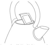
ケトルの中の注ぎ口部分にフィルターが 装着されていることを確認してください。 フィルターが装着されていないと、オートオフ機能 が働きにくくなります。
