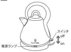
電源プラグをコンセントに差し込み、スイッチを押し下げます。湯沸し中には電源ランプが点灯します。湯沸し途中でケトル本体を持ち上げるとスイッチは自動的にオフになります。
